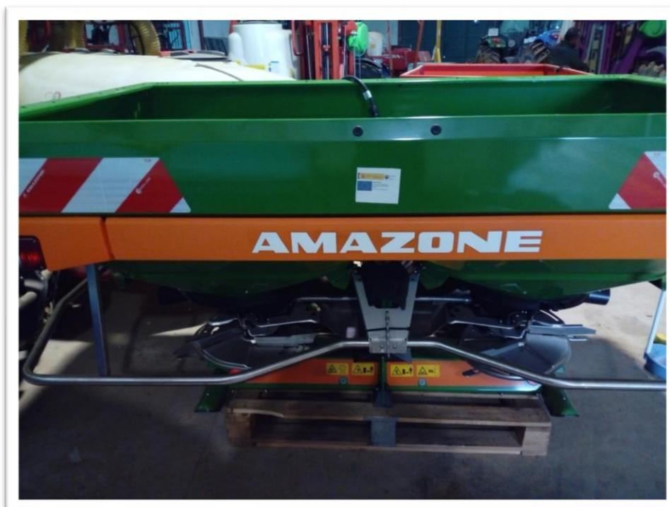
**Figura 1.** Abonadora de distribución variable de fertilizante Amazone ZA-V Profys Hidro
