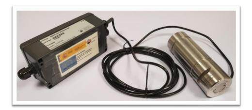
• 2 célula de carga tipo pancake con rango de medida de 0-10 toneladas. Tienen grado de protección IP67. Dispone de la electrónica amplificadora para la adaptación de la salida de la célula a una salida estándar 0-10 V o 4-20 mA. Son idóneos para aplicaciones generales de medición de tensión y compresión en maquinaria agrícola.
