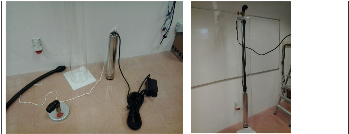
Fig.5 .- Simulador del pozo con electrobomba de 4" sumergida
