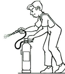
Coger la boquilla del extintor y comprobar, en caso de que exista, que la válvula o disco de seguridad está en una posición sin riesgo para el usuario.
