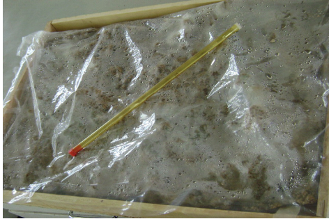
Figure 1. A fermentation tray with the cellophane wrapper that ensures optimum water activity within the fermenting substrates. Visible are the refluxing water droplets. (Una bandeja de fermentación con la envuelta de celofán que asegura una óptima actividad del agua dentro de los sustratos en fermentación. Son visibles las gotas de agua de condensación).
