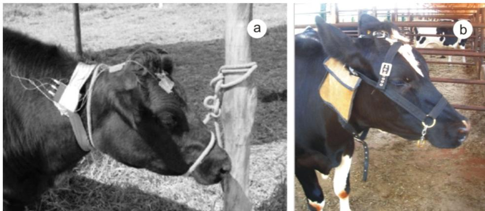
**Figura 5.** Animal equipado con un nodo sensor. (Animal carrying a sensor node).
