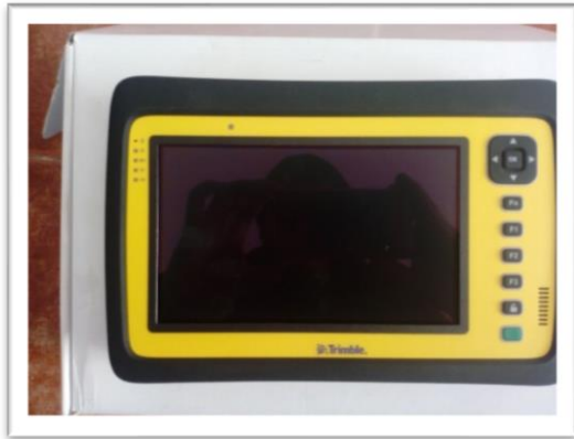
Figura 2. Equipo portátil de posicionamiento para obtención y registro de coordenadas de puntos geográficos. Trimble ROD-GNSS Range Pole
