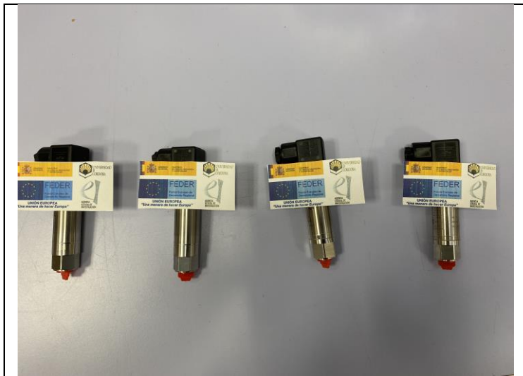
Figura 2. Sensores extensométricos de presión
