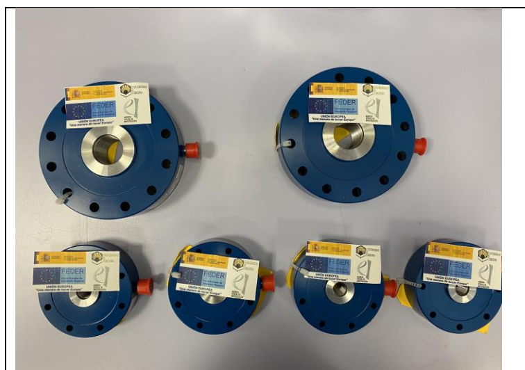
Figura 3. Sensores extensométricos de fuerza (Células de carga)
