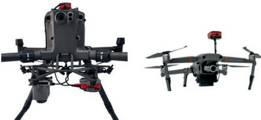
Figura 18.5. Soporte multisensor para DJI Matrice 200 (izq.) y soporte sensor multiespectral para DJI Mavic 2 (der.).
