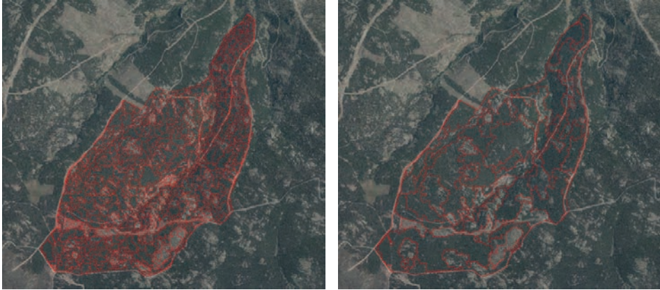
Figura 11.6. Dos ejemplos de segmentación. La imagen de la izquierda muestra rodales resultantes de tamaño pequeño, muy uniformes internamente, pero también muy parecidos entre sí. La imagen de la derecha muestra rodales resultantes de gran tamaño, muy diferentes unos de otros, pero con baja coherencia interna.
