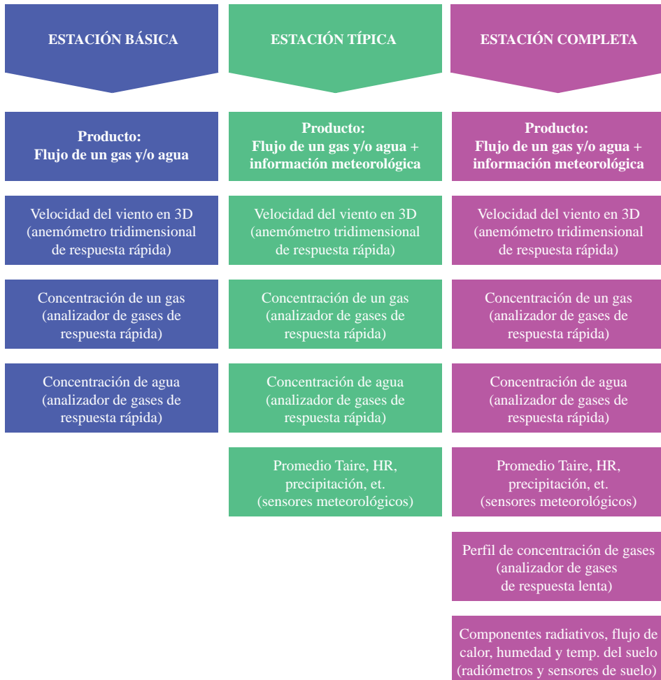
Figura 2.4. Diseño experimental de una estación de EC.
