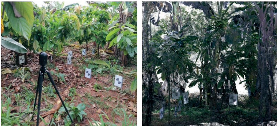
Figura 12.5. Posicionamiento de las dianas dentro del área de acción del láser escáner (izq.) y visualización en la nube de puntos LiDAR (dcha.).
