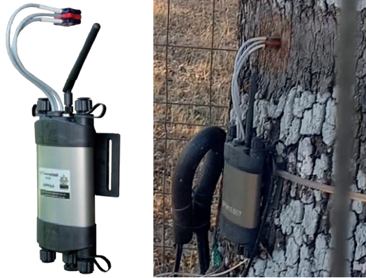
Figura 1.15. Sistema de medición flujo de savia aplicando método de pulso de calor: sensor SFM1 de ICT International Ltd. (ver especificaciones en la Tabla 1.5).
