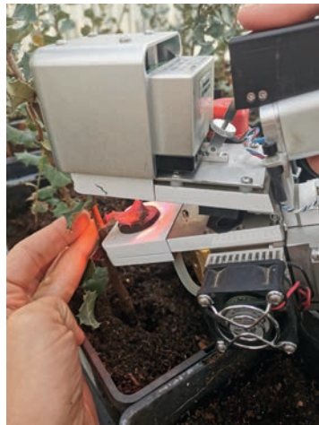
Figura 1.20. Detalle de la cámara de medida del LI-COR LI6400XT, con el sensor de fluorescencia y emisor de luz PAR acoplado.
