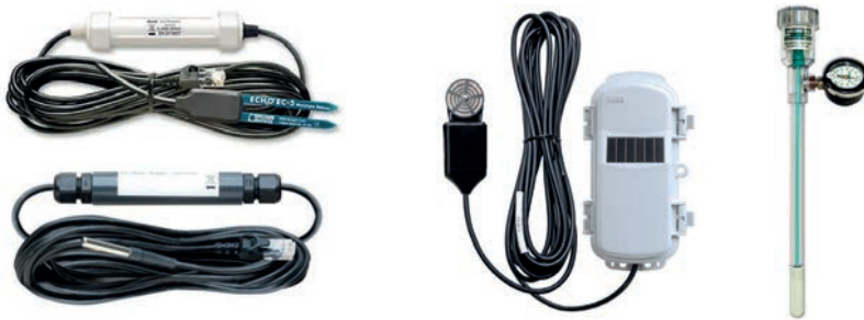
Figura 1.14. Ejemplos de sensores de variables de estado de energía del suelo: sensores HOBOTemp de contenido volumétrico de agua (S-SMC-M005) (sup. izq.) y de temperatura del suelo (S-TMB-M002) (inf. izq.), que se conectan al data logger mediante un puerto USB; sensor inalámbrico HOBOPotential RXW TEROS 21 de potencial de agua en el suelo y temperatura; tensiómetro 64xx series de SpectrumTechnologies (dcha.) (ver especificaciones técnicas en la Tabla 1.4).
