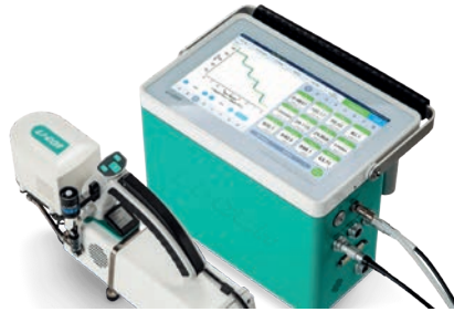
Figura 1.19. Sistema de medición de fotosíntesis portátil LI-6800 LI-COR (ver especificaciones en la Tabla 1.7).
