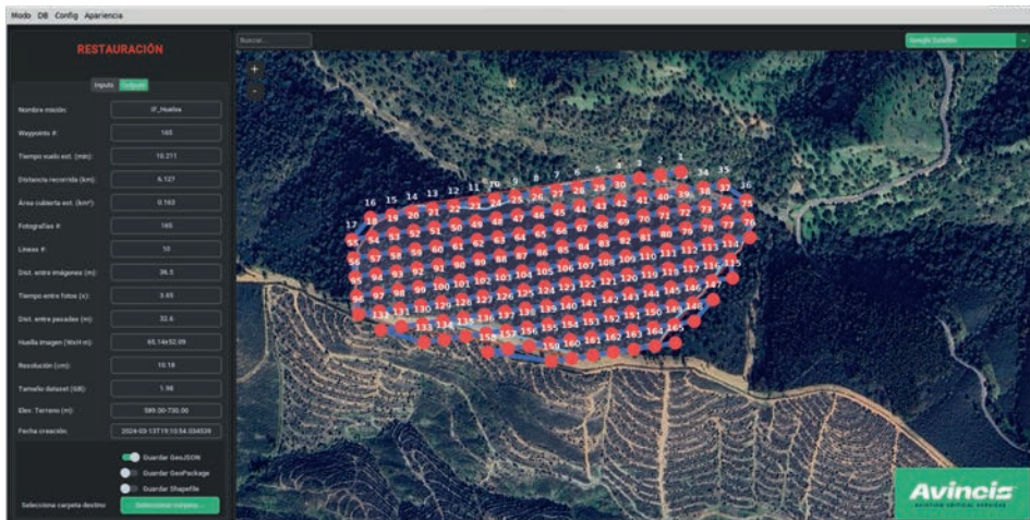
Figura 19.9. Plan de vuelo de fotogrametría dentro de un polígono.
