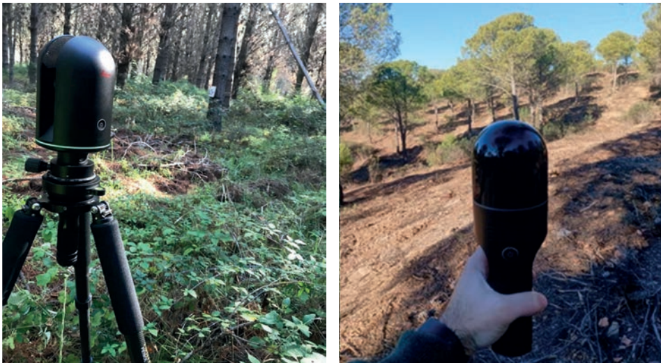
Figura 12.3. Diferencias en el proceso de toma de datos entre escaneo láser estático (izq.) y dinámico (dcha.).
