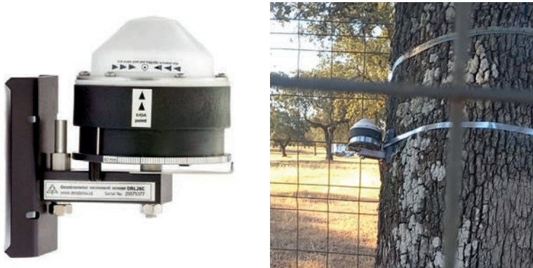
Figura 1.21. Dendrómetro de banda automático DRL26C de Environmental Measuring Systems Brno (ver especificaciones en la Tabla 1.8).
