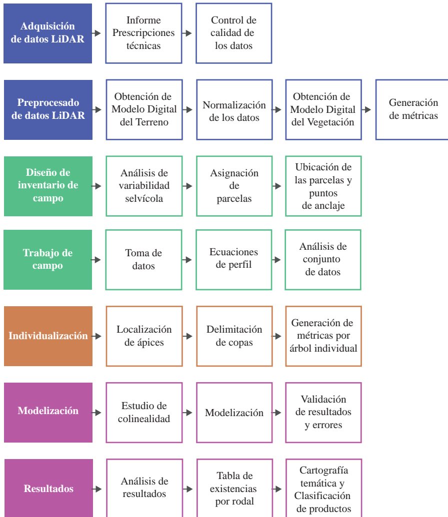
Figura 10.7. Metodología LiDAR para inventarios forestales basados en áreas (rodales) (ABA).
