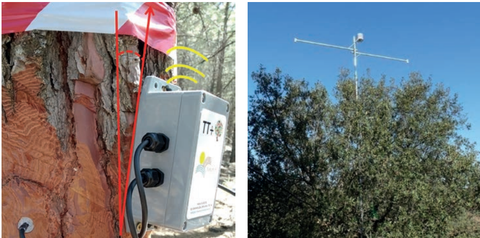
Figura 1.24. Sensores de transmitancia y reflectancia de copa: sensor TreeTalker (Nature 4.0) equipado con un sensor zenital multispectral de 12 bandas (se instala bajo copa, en el tronco, con una inclinación entre 15 y 25° sobre la vertical del tronco) (izq.); sensor de reflectancia y NDVI y dos sensores de infrarrojos Apogee de Edaphic Scientific instalados sobre la copa de una encina (dcha.).
