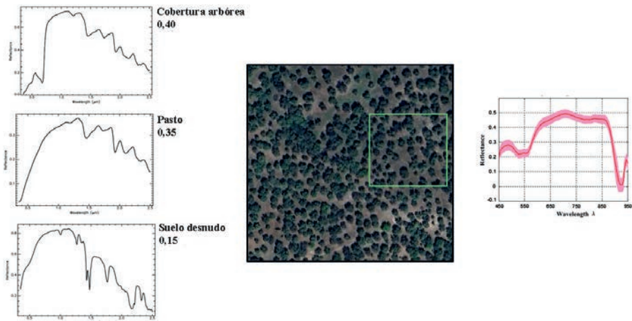
Figura 8.5. Métodos de generación de espectro a partir de la mezcla de espectros distintos dentro de un pixel.
