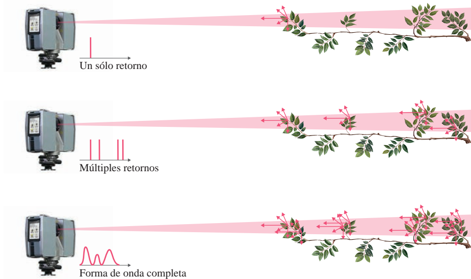
Figura 12.1. Modalidades de detectores LiDAR según el número de señales de retorno calculadas para cada dirección y las capacidades de detección del sensor: captura de un solo retorno (sup.) (primer objeto que refleja una parte del pulso láser); captura de múltiples retornos (centro); y captura la forma de onda completa de la señal de retorno (inf.) (basado en Dassot et al. (2011)).
